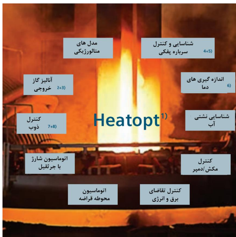
شکل ۲. سیستم کنترل جامع EAF Heatopt همراه با زیرمجموعه‌های آن.
