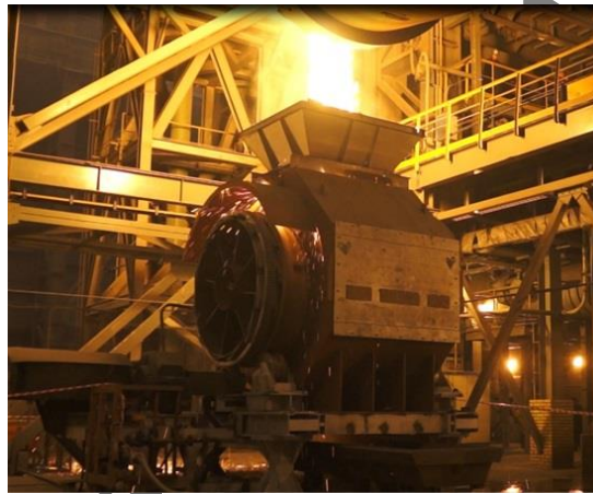
شکل ۲: درام کریستالیزاتور کلوخه ساز سرباره
