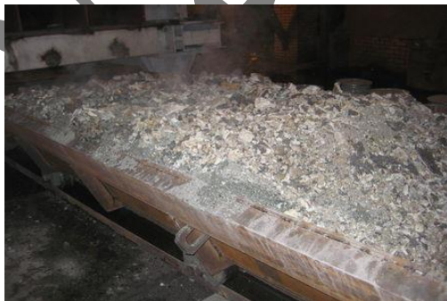
شکل ۲: درام کریستالیزاتور کلوخه ساز سرباره
