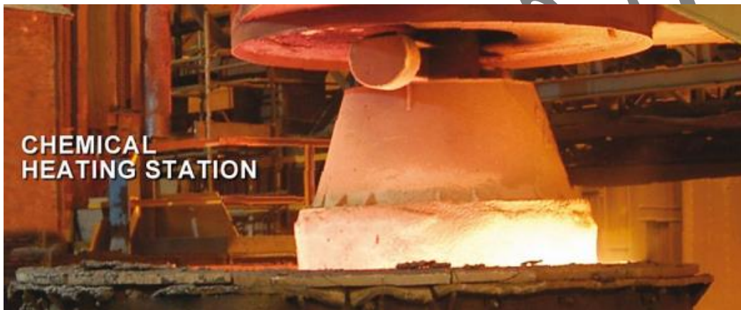
شکل ۳. پاتیل ناقوسی شکل نسوز در فرآیند CAS-OB
