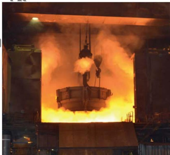
شکل ۱: جرثقیل اتوماتیک برای شارژ قراضه به کوره.
