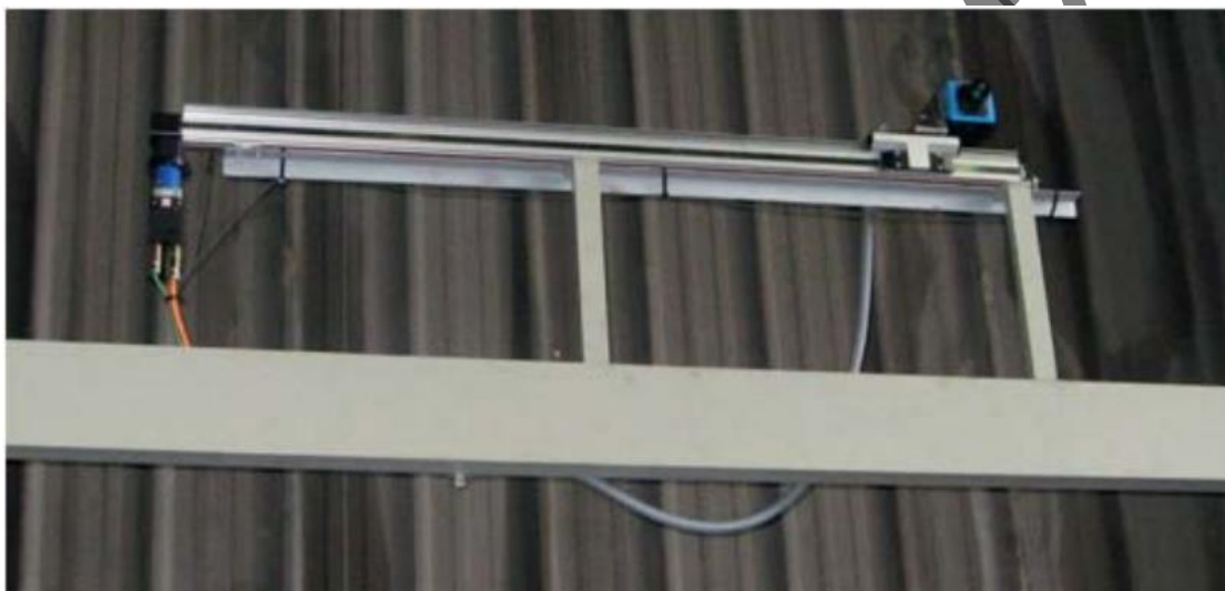
شکل ۲: طراحی ساده، ارزان قیمت و پربازده با کمک اندازه‌گیری موقعیت به روش لیزری برای افزایش دقت در عمل.
