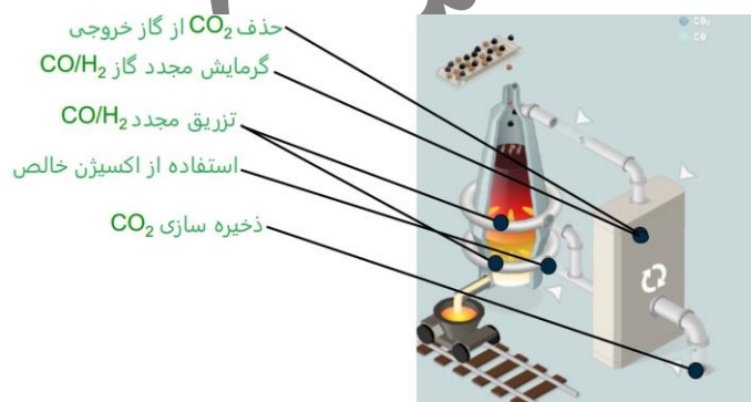
شکل ۲: شماتیک اجزای فرایند TGR-BF معرفی شده توسط کنسرسیوم ULCOS.
