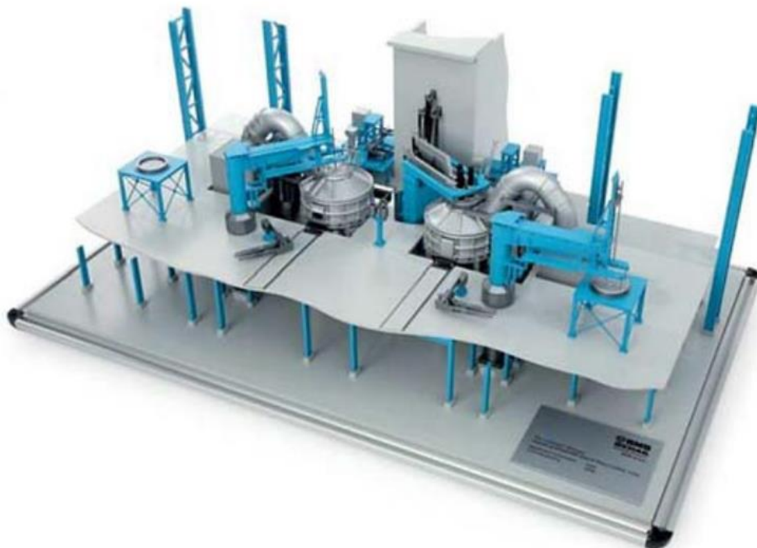
شکل ۳. نمایی از تکنولوژی CONARC با حضور دو کوره قوس و کنورتور در کنار هم.
