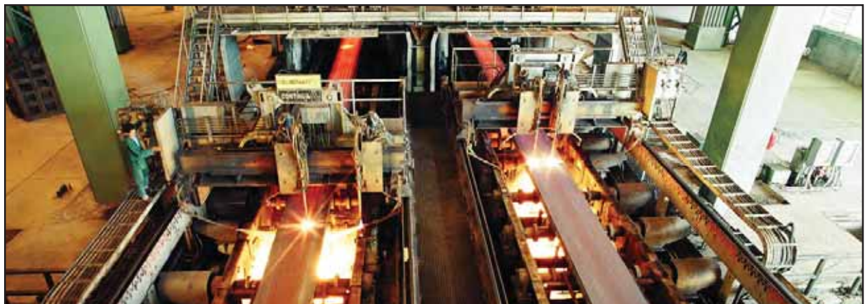
شکل ۲۳. سیستم ریخته‌گری پیوسته با تمامی تجهیزات و رویکردها جهت تولید فولاد ریخته‌گری شده با کیفیت بالا (SULC) [۴۰].
