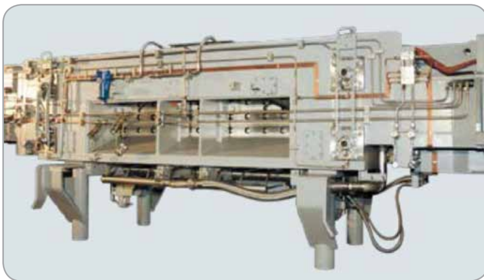
شکل ۱. قالب هوشمند برای ریخته گری پیوسته تختال.
