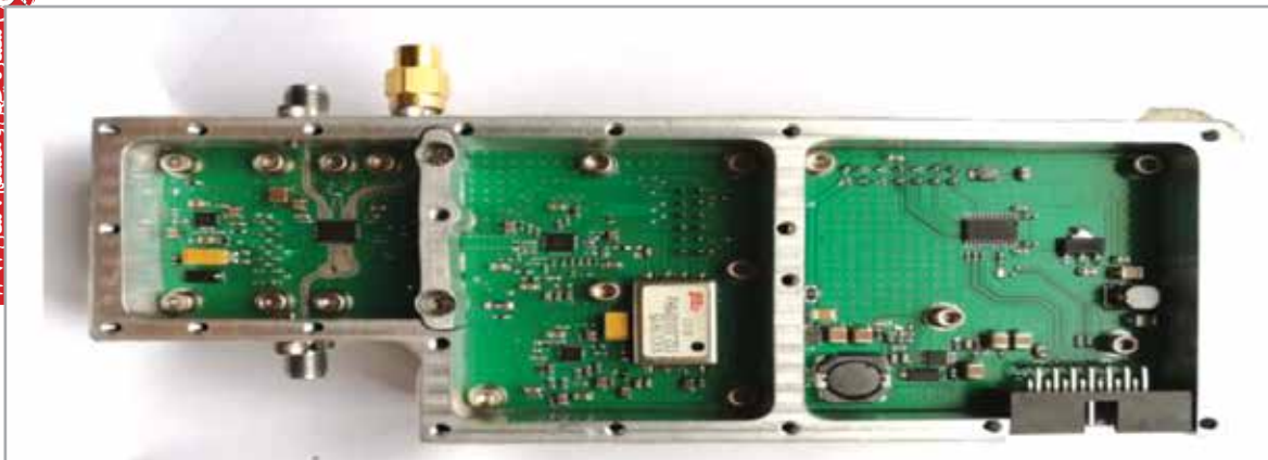
شکل ۵- نمایی کامل از تجمیع بخش‌های رادیویی و اینترفیس مدل آزمایشگاهی سامانه در جعبه طراحی شده
