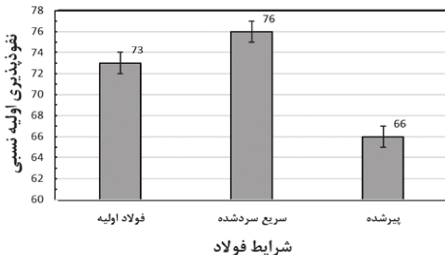
شکل ۷- نفوذپذیری اولیه نسبی فولاد در شرایط مختلف.
