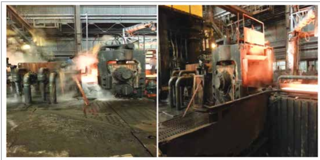
شکل ۲ نمایی از بخش برش تختال در خط نورد گرم را نشان می دهد.
