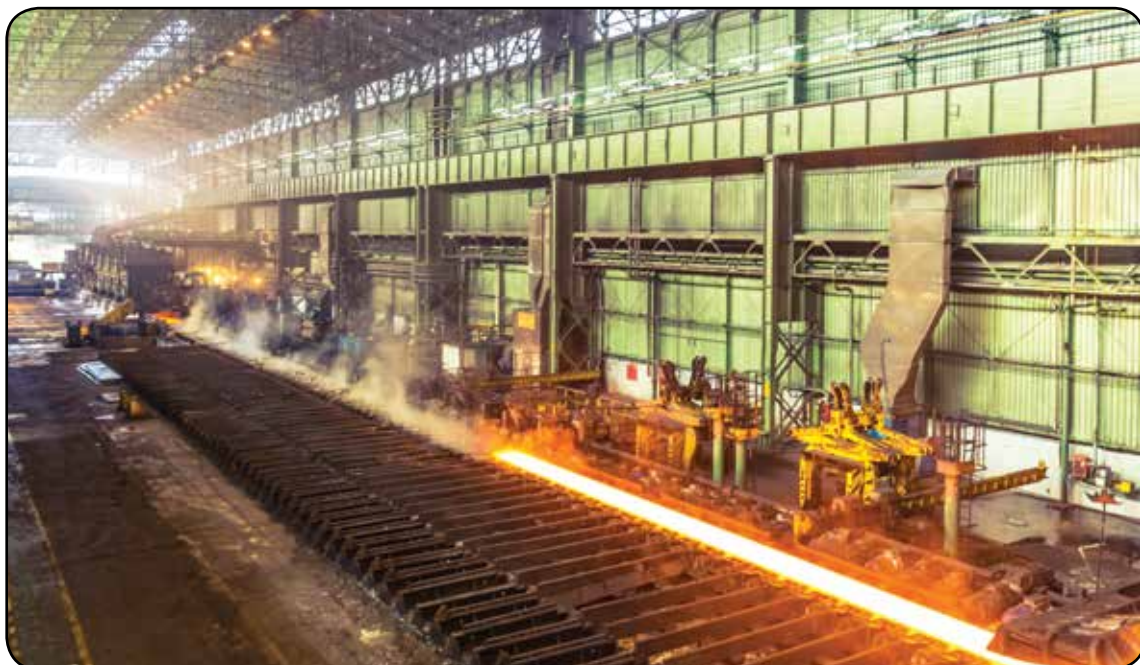
شکل ۲ نمایی از بخش برش تختال در خط نورد گرم را نشان می دهد.
