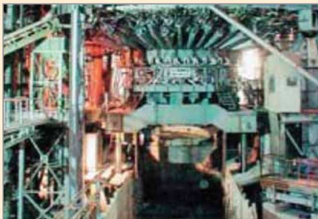
شکل ۱۳- کوره قوس الکتریکی جریان مستقیم با تکنولوژی CIRCOARC
